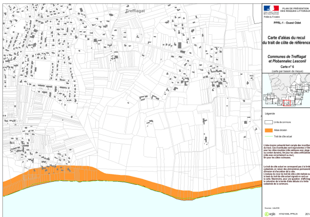
Exemple de cartographie de l'aléa érosion
