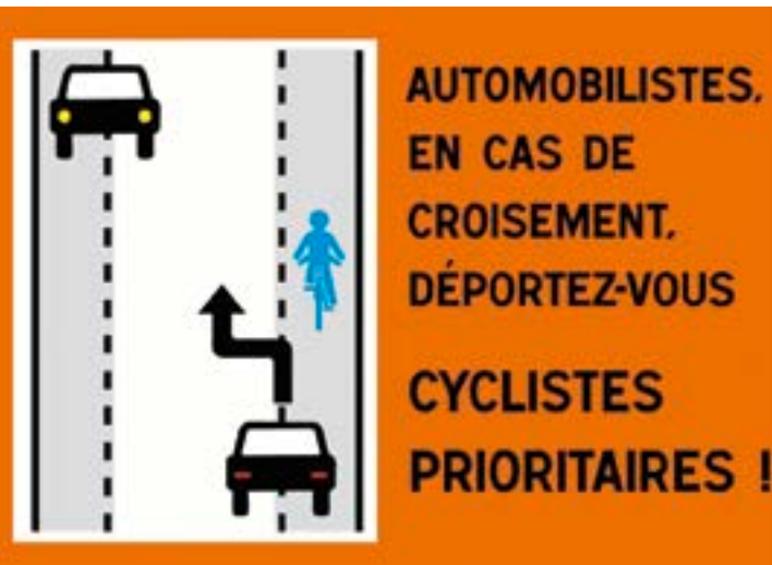
Principe du système "Chaucidou"
